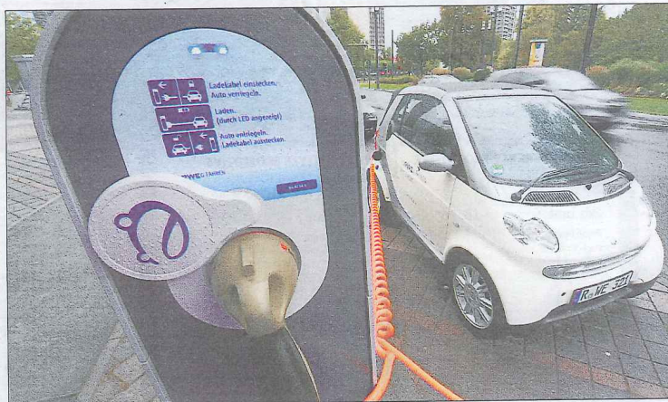
La Smart ForTwo ED disposera de deux places et sera dotée d'un moteur électrique de 41 chevaux lui offrant une autonomie de 115 kilomètres
